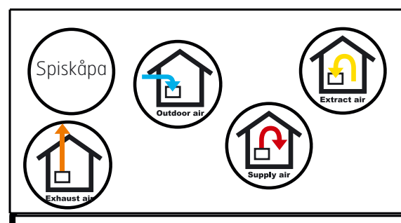
Aggregat sett från ovan - Luftriktning
